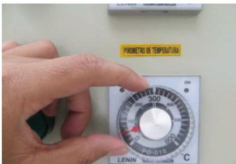
**5** Ajuste el pirómetro inferior a 50°C girando en el sentido del reloj
