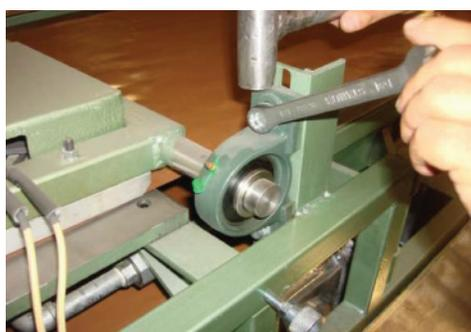
**2** Afloje los tornillos de la chumacera con la llave correspondiente y después bájela suavemente si desea disminuir el grosor en la parte inferior del textal. Haga el mismo procedimiento con la chumacera del otro extremo. Para aumentar el grosor, suba las chumaceras.
